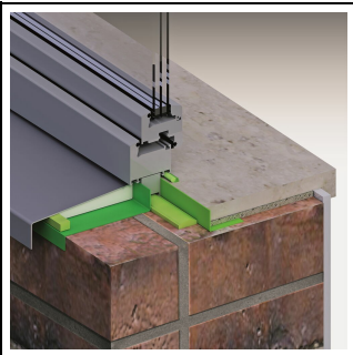
1. Bild: Lösungsmöglichkeit: Innen: ME500 TwinAktiv EW mit SP025 Fensterfolienkleber Öko, Mitte: FM220 Multi-Bauschaum, Außen: ME500 TwinAktiv EW mit SP025 Fensterfolienkleber Öko.
